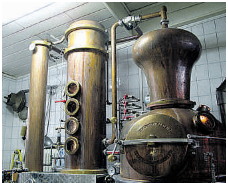
Der Weg eines Edelbrandes: Im Brennkessel (rechts) steigen Alkohol und Aromen auf, der Weg führt durch den Kolonnenturm zum Ablauf (links).
